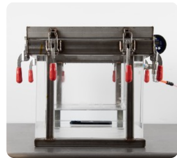
För att testa IPX7/8-skydd mot nedsänkning i vatten sänker Apple ner en iPhone i ett trycksatt kärl för att simulera det tryck som upplevs under vattnet.
