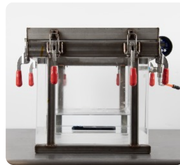
Pri preskusu zaščite pri potopitvi v vodo IPX7/8 Apple potopi iPhone v posodo pod tlakom, da simulira tlak pod vodo.
