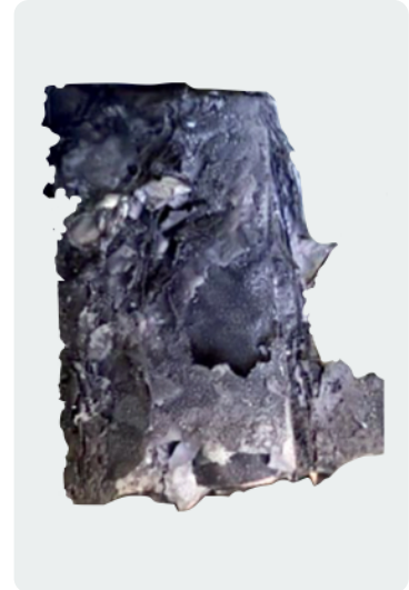
Batterij van derden na een test waarbij wordt gekeken wat er gebeurt wanneer een batterij boven de gestelde limiet wordt opgeladen.
