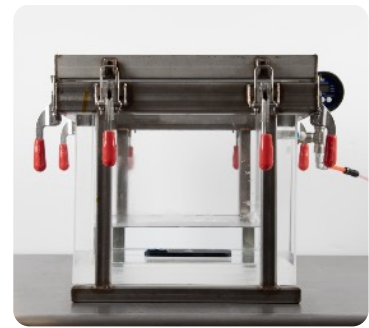
Upotuksen kestävyys testauksessa (IPX7/8-luokitus) Apple upottaa iPhoneen paineistetussa astiassa olevaan veteen veden alla vallitsevan paineen simuloimiseksi.
