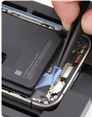
Las baterías del iPhone se fijan con adhesivos avanzados diseñados para sacarlas cuando se manipulan en una dirección específica, lo que permite el reemplazo de la batería.
